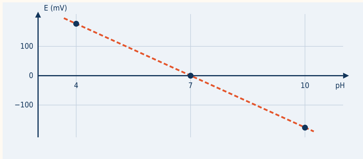
Tension E en fonction du pH pour trois tampons (4,00 ; 7,00 ; 10,00).
